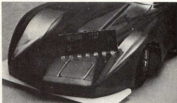
Fig. 1 - Esempio di modellino di vettura per gare automobilistiche su pista, impiegante un circuito integrato Signetics tipo NE544, per la sezione del servo-controllo.
