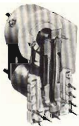
Fig. 14 - Trasformatore E.A.T., relativo ad un televisore bianco e nero della Phoenix (codice GBC, ME/1551-00).
